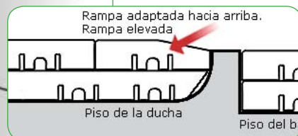
Ejemplo de rampa elevada hacia el nuevo nivel de piso de la ducha
